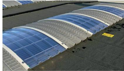
Die widerstandsfähigen Trapezprofil-Hohlkammer-Plattensind aus 8 mm, 10 mm oder 16 mm starken Polycarbonat-Hohlkammern, mit 40 mm hohen Wellen im Abstand von 250 mm. Die UV -beständige Außenschale ist mit 3-wandiger Struktur sehr stabil und für Oberlichten und flachgebogene Abdeckungen bestens geeignet. 1000 mm Deckbreite und heißverschweißte Enden ermöglichen eine einfache Montage.
